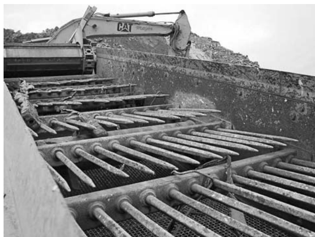
3. ábra Szurony alakú rostélyrudak, melyen az anyag többször átfordulva halad lefelé, eközben a rárakódott föld leválasztódik
