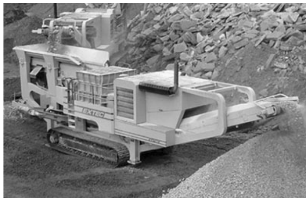
2. ábra Dolgozik az Extec mobil hengeres törő
