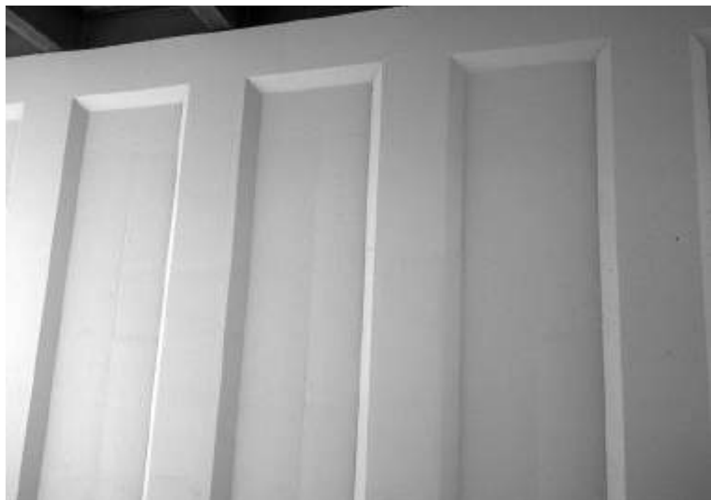
5. kép A felület szép, zárványoktól mentes lett
