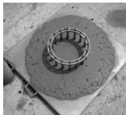
3. kép Az öntömörödő beton terülésének mérése blokkolóürről
