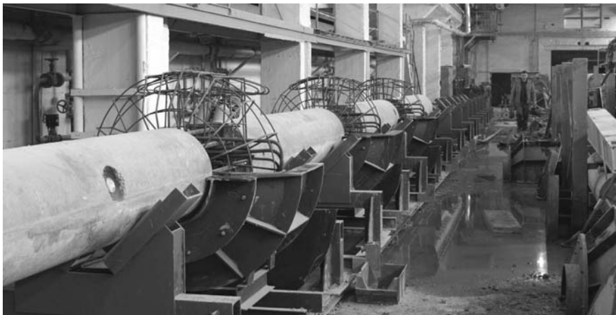
2. ábra Félkész oszlopok a gyártócsarnokban
