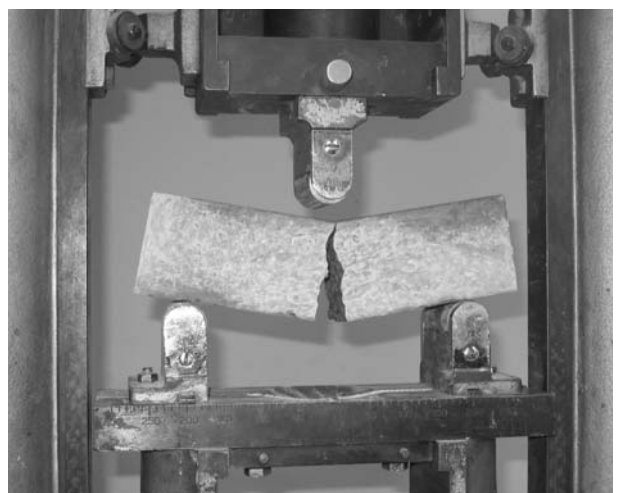
2. ábra Hasáb hajlító-húzó vizsgálata
