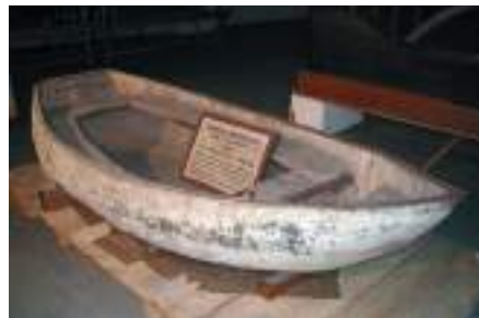
4. kép Lambot vasbeton csónakja: 1849
