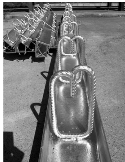
5. ábra Tűzihorganyzott betonacélok alkalmazása nálunk még csak esetleges (Fotó: Antal Árpád)
