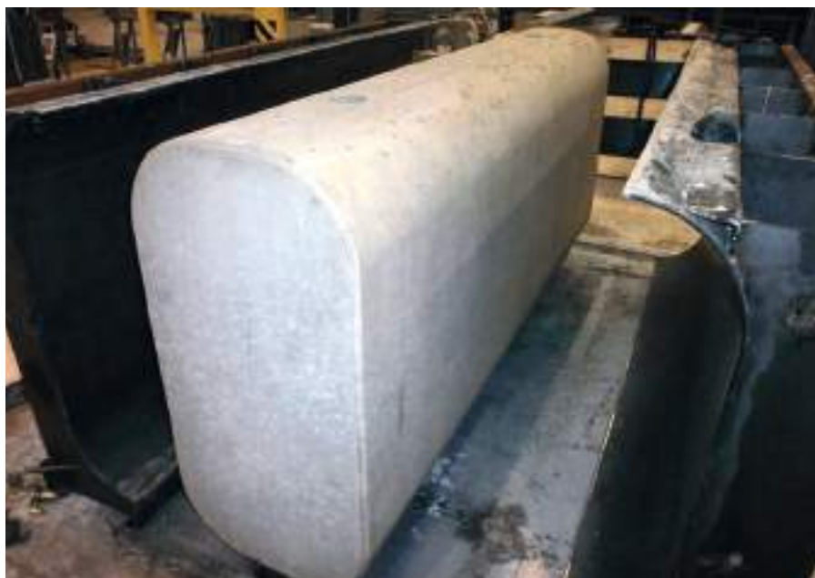
1. kép A próbaelemen jól látható a gyártástechnológia (alul és felül 12 -12 cm vízszintes felület: alul a fenékszalú miatt, felül pedig a beton betöltéséhez)
