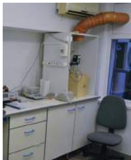
3. kép Kaloriméterek a cement hidratációs hőjének mérésére. Felül háttérben a fél adiabtikus kaloriméter (előtte a mész reakcióképesség mérő), alul az oldáshő kaloriméter
