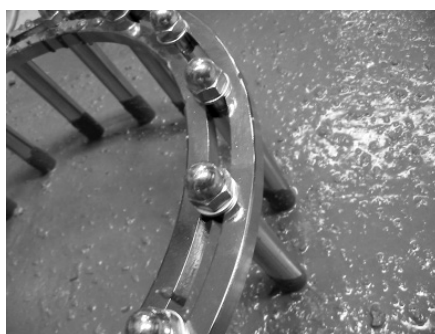
5. ábra Blokkolódási hajlam vizsgálata J-ring eszközzel
