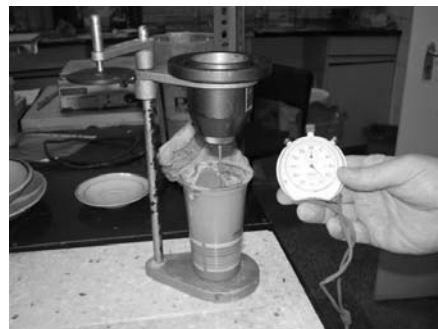
2. ábra Pép és paszta átfolyási idejének vizsgálata
