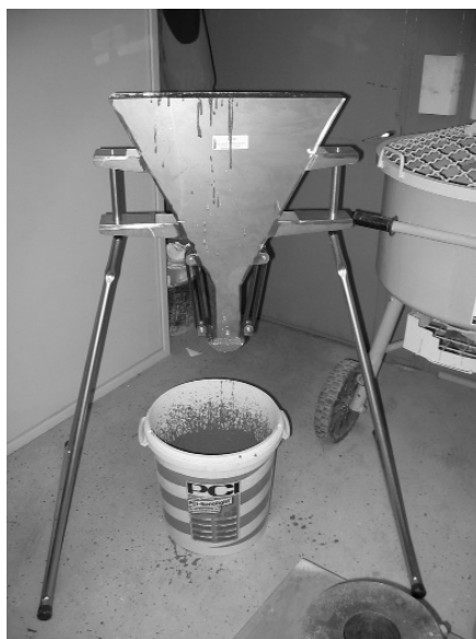
6. ábra Átfolyási-idő vizsgálata V-Funnel eszközzel
