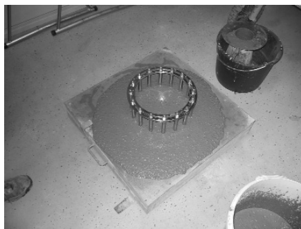
4. ábra Blokkolási területvizsgálat J-ring eszközzel
