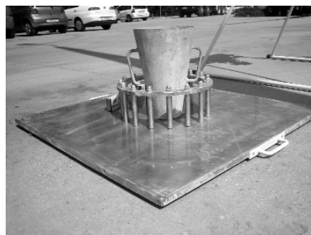
1. ábra Terülmérésre várnak az eszközök
