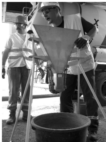
3. ábra A kifolyásmérés kezdetének pillanata
