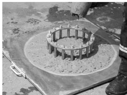
2. ábra Terülmérés a blokkoló gyűrűvel
