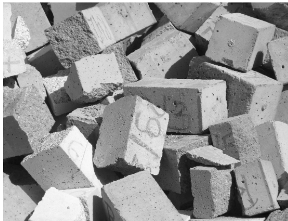
1. ábra Különböző beton próbatestek törés után
