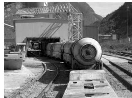
5. ábra A beton szállítását biztosító vasúti mobil mixerek képe
