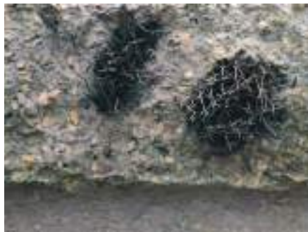
1. kép Szálak csomósodása beton elemekben
