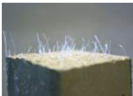
6. kép Szálerezősített beton törésképe
