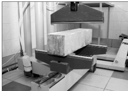
2. ábra Hasáb próbatest vizsgáltra előkészítve
