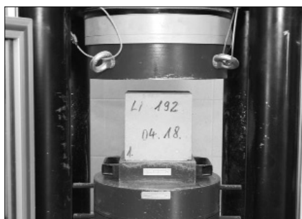
3. ábra Betonkocka a törőgépbén
