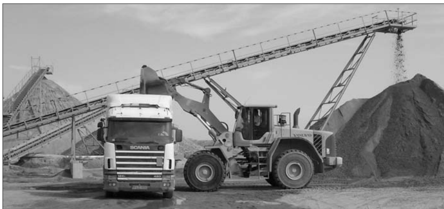
5. ábra A megrendelt frakciójú kavicsot szállítójárműre rakják
