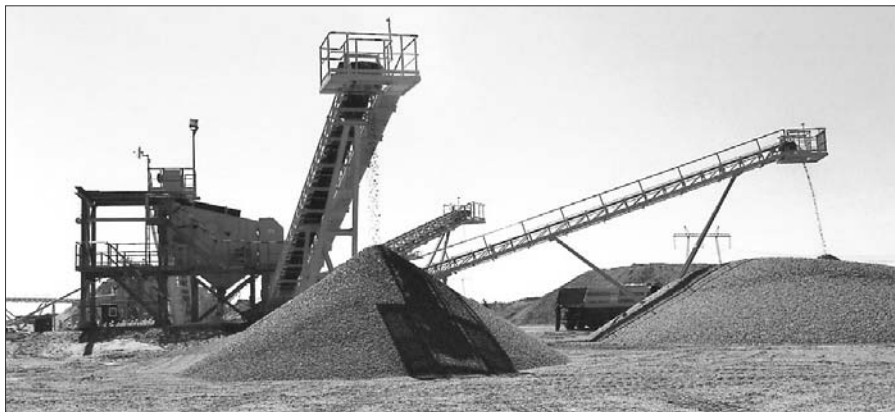
4. ábra A frakcióra bontott homokos kavicsot szállítószalagok viszik a depóniákba
