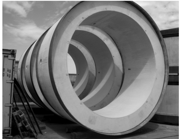
4. ábra Kerámia betonból készült szennyvíz csatorna elemek a tárolótéren
