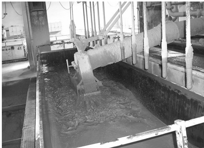
1. ábra A friss betonkeverék sablonba öntése
