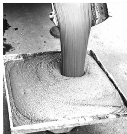
7. ábra Pernyebeton folyékonyága
