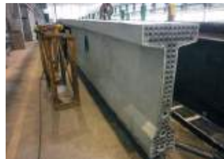
4. kép Az egyik gerenda az üzemben, a kapcsolódó felületen a mélyedésekkel
