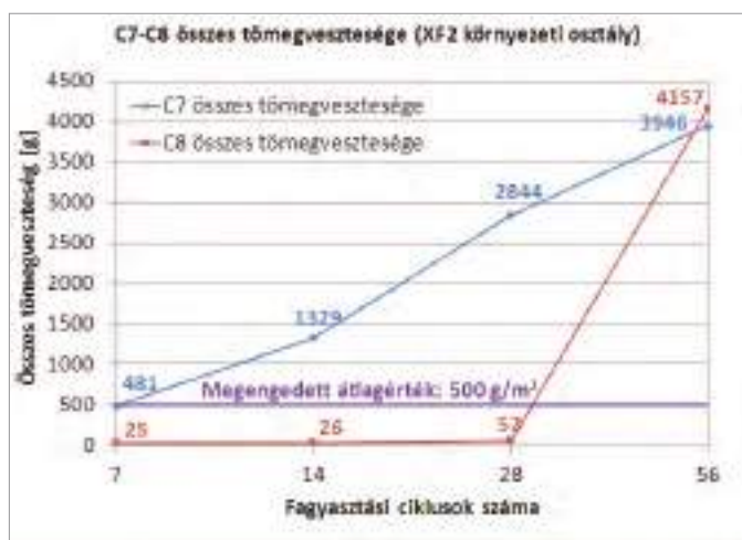
4.3. ábra C7 és C8 keverékek összes tömegvesztése XF2 környezeti osztály szerint vizsgálva (olvasztósóval) 56 ciklus után
