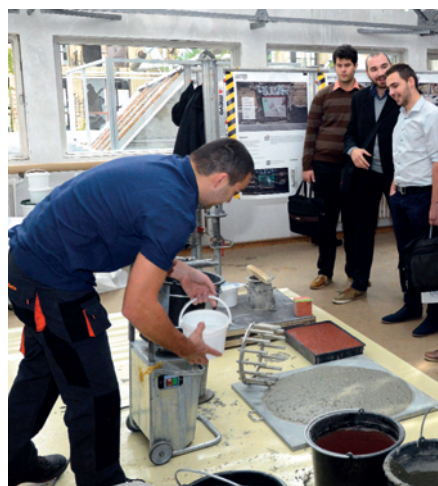
7. kép Öntömörödő beton területének mérése a gyakorlati bemutatón
