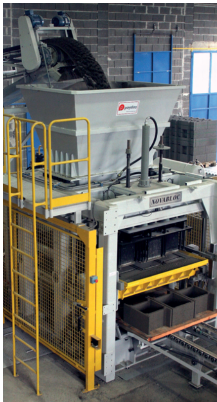
3. kép Az új telepített betonblokk-üzem 40-es zsalukövet gyárt
