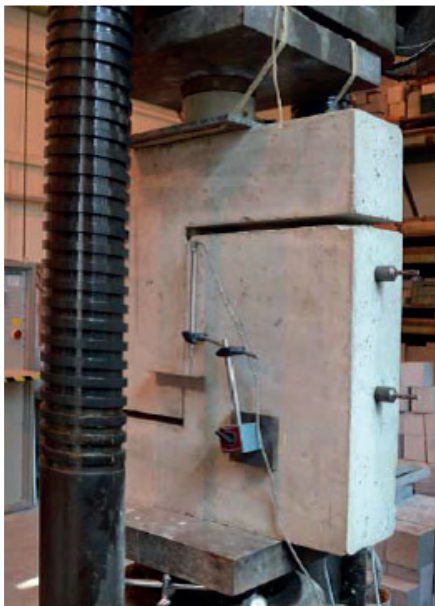
8. kép Kapcsolati elemek terhelésvizsgálata
