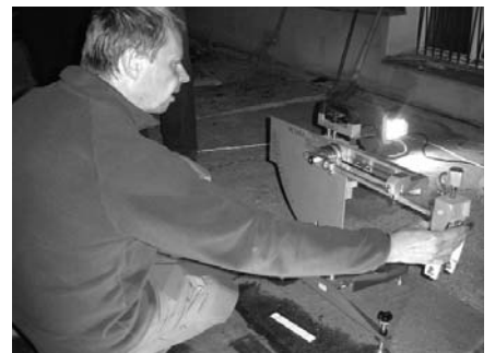
5. ábra Csúszásellenállás mérése hagyományos beton burkolaton
