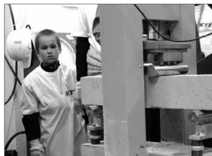
3. ábra Szálerősítésű betongerenda a törés előtti pillanatban
