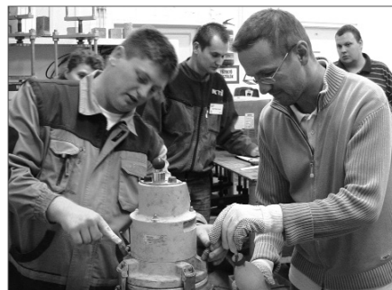
2. ábra Frissbeton vizsgálat: levegőtartalom mérés
