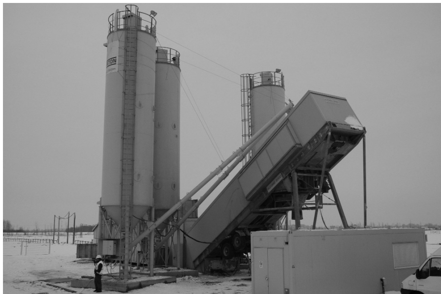
2. ábra A Mercedes-Benz gyár építési területén felállított EUROMIX 2000 SBM 2.25 típusú mobil betonkeverőgép
