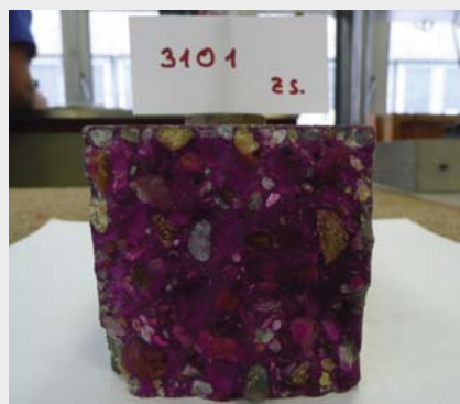
5. ábra Folyósító adalékszerrel és anélkül készített, különböző módon tárolt, illetve utókezelte betonok karbonátosodási mélységének vizsgálata
