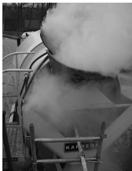
2. ábra Az elpárolgó hideg nitrogén gáz ködképződés mellett a környezetbe kerül
