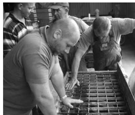
3. ábra A munkagépre szerelt keverőadapter vizuális lehetőséget ad az NSZ-NT beton készítéséhez
