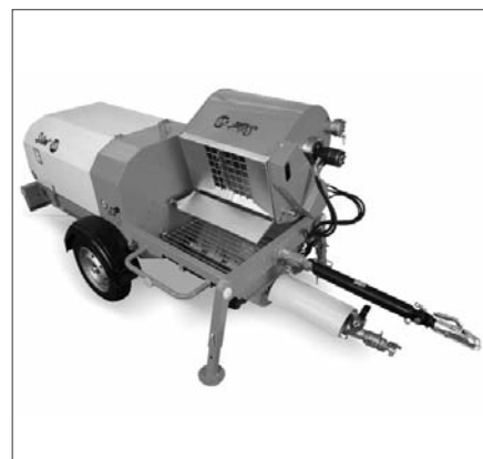
3. ábra Silent 300 hidraulikus csavarszivattyú vakolatokhoz, saját, vízszintes tengelyű kényszerkeverővel
