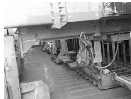
4. ábra A kereszt- és a hossz-hézag vasakat automatikusan elhelyező berendezés
