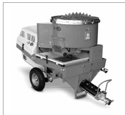
4. ábra Step 120 elektromos csavarszivattyú vakolatokhoz, saját, függőleges tengelyű kényszerkeverővel
