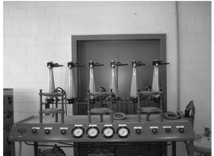
4. ábra Vízzáróság vizsgáló berendezés A beton nyomás alatti vízfelszívását a maximális vízbehatolással mm-ben lehet mérni egy meghatározott időtartam és adott nyomás esetén. (24 óra időtartam 5 bar nyomáson az MSZ EN 12390-8 szabvány szerint.)
