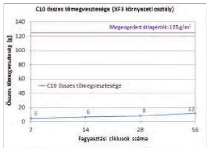
4.4. ábra C10 keverék összes tömegvesztése XF3 környezeti osztály szerint vizsgálva (olvasztósó nélkül), 56 ciklus után
