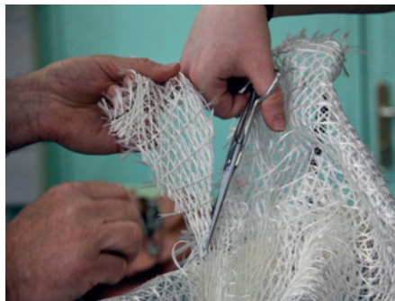
4. kép Az üvegszálalás háló méretre vágása
