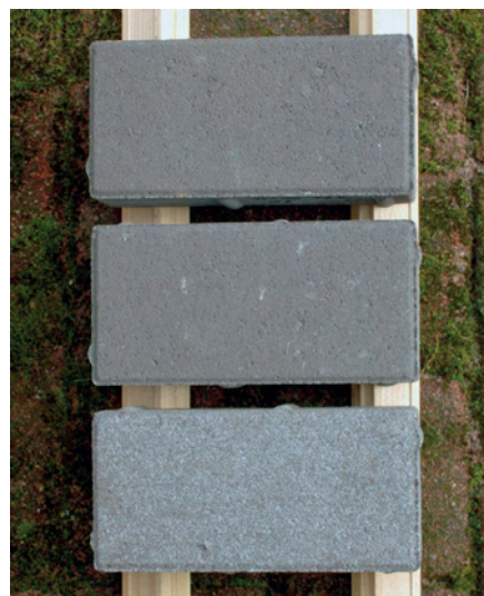
1. kép Antracitszürke beton burkolókövek Alul egy Murasan Hydrotech 884 hozzáadása nélkül készült burkolókő látható, amelyen egy nap elteltével erős kivirágzások jelentek meg. A középső burkolókő betonjához 0,3% Murasan Hydrotech 884 terméket adagoltak. Itt nem látszanak kivirágzások és jó a színmélység. A felső betonkő 0,4% Murasan Hydrotech 884-et tartalmaz és egyértelműen a legjobb eredményeket mutatja. Fotó: MC-Bauchemie
