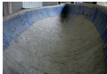
7. kép A peremet erősítő háló elhelyezése
