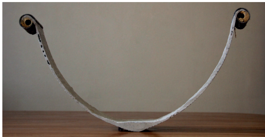
1. kép A NAVIS CAEMENTICIA betonkenu keresztmetszete
