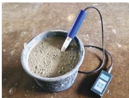
2. ábra: Víztartalom gyors meghatározása mobil mérőszondával
