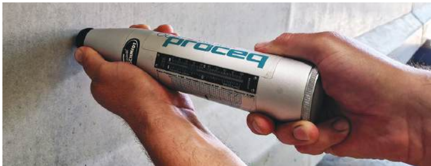
4. kép: Schmidt-kalapácsos vizsgálat feszített gerendán
