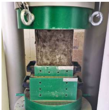
3. ábra Szabványos próbakocka tönkremenetele nyomószilárdság vizsgálata során
