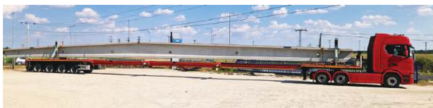
5. kép: 40 méter hosszú feszített tetőszelemen gépjárműre rakodva az üzemi tárolóterületen
