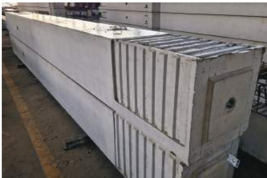
2. ábra: Öntömörödő betonból előállított pillérek a késztermékdepóban
