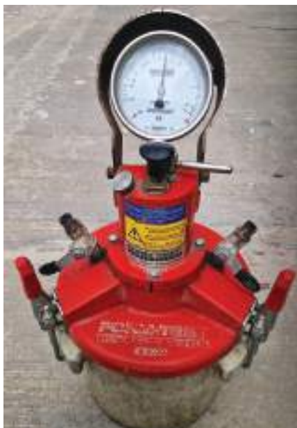
3. ábra: Frissbeton levegőtartalom-mérése nyomásmódszerrel
