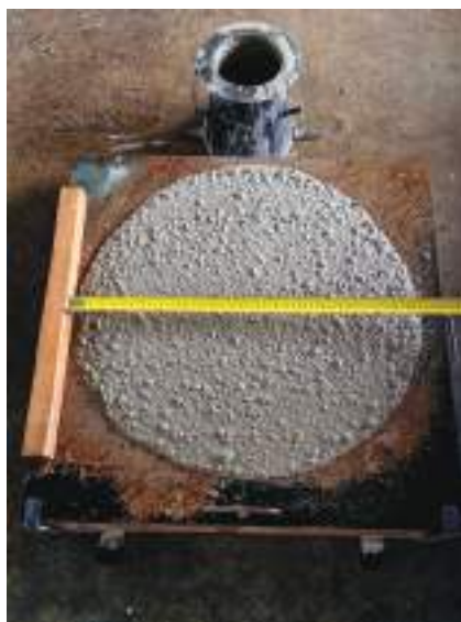
1. ábra: Terülesmérés F5 konzisztenciaosztályú frissbetonon
