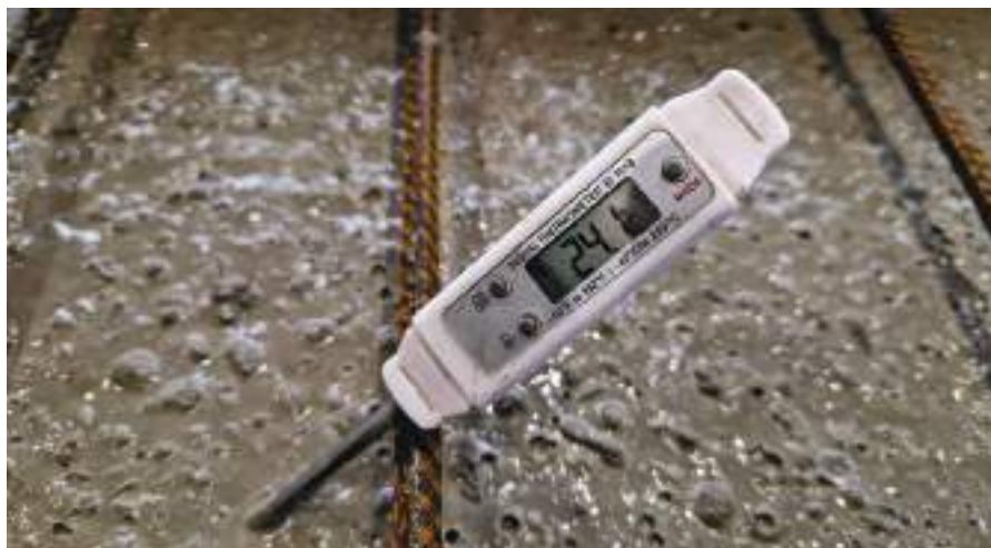
4. ábra: Frissbeton hőmérsékletének mérése beszúrószondás hőmérővel
