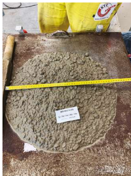
Konzisztencia-eltarthatóság 10 cm terülés csökkenéséhez szükséges idő MSZ EN 12350-5:2019 szerint
