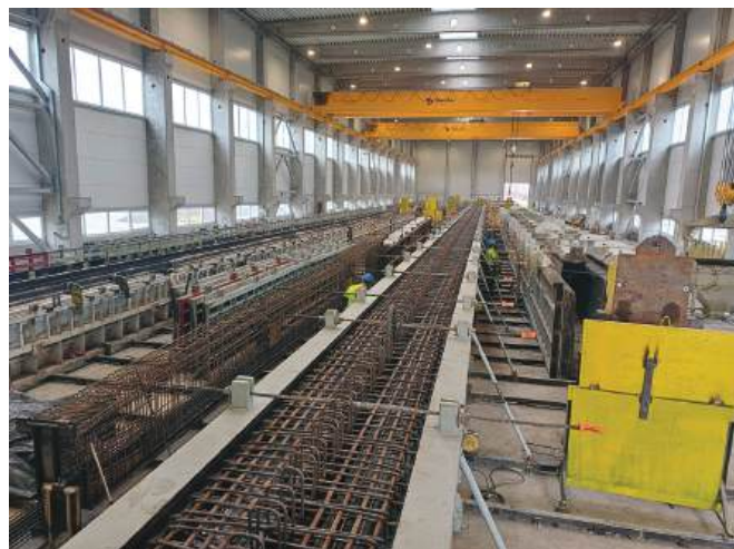
6. kép: Öntés előtti utolsó ellenőrzés a sablonon és a vasvázon.
