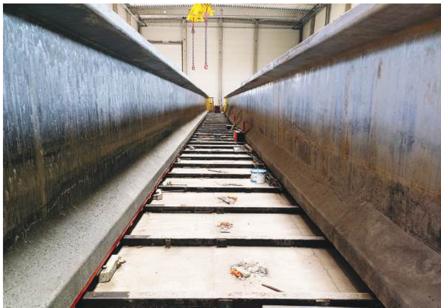
1. kép: FI 200-as tartók. Bal oldalon a könnyű adalékanyagos, jobb oldalon a normál betonnal készült hídgerenda.
