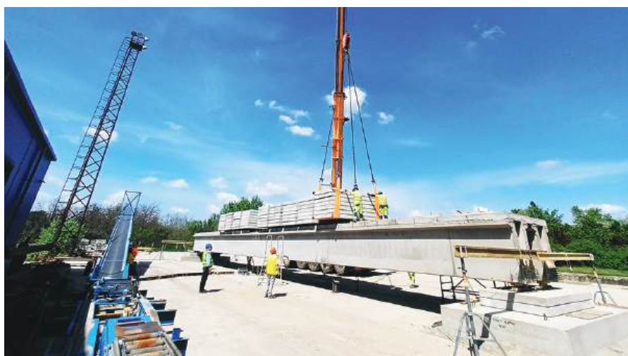
5. kép: Az U tartók próbaterhelése.
