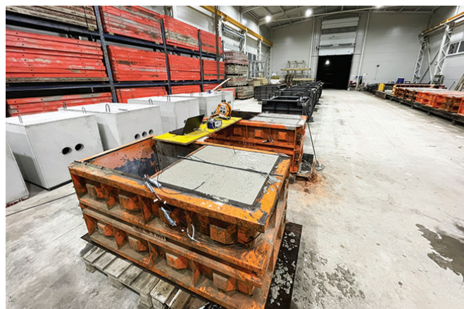
2. kép: Nagy méretű próbatestek betonozás után
