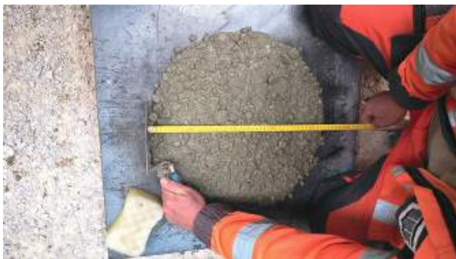
3. kép: Megfelelő terülésű beton – F3 konzisztencia-osztályba tartozik. (fotó: Betonmix Kft.)
