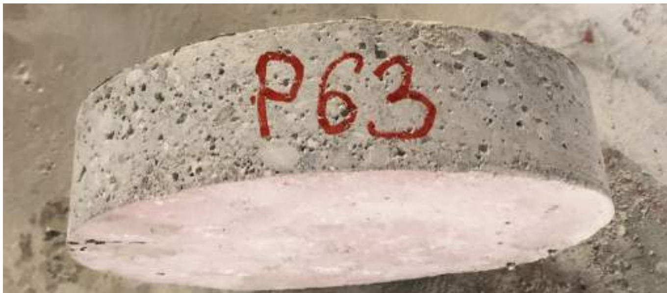
1. kép: Kb. 40 éves, de jó állapotú esztrichpadozat keresztmetszete, alkalmas az új burkolat fogadására.
