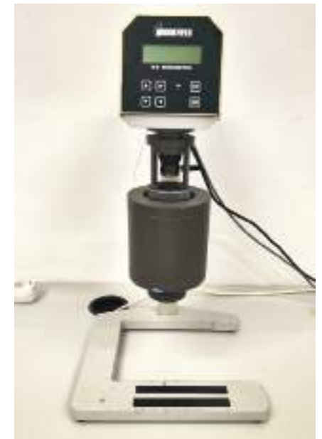
1. kép: Brookfield R/S reométer
