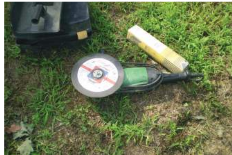
A védőburkolat hiányzik a vágókorongról
