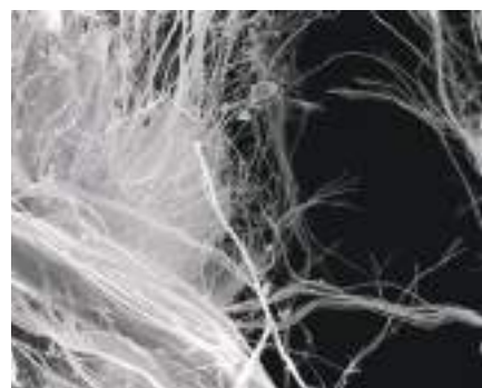
A feldolgozott azbeszt mikroszkópi képei
