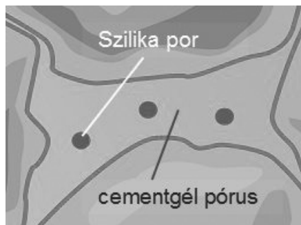
9. ábra Szilikapor és alumoszilikát adalékanyagok a cementkő porusvizében
