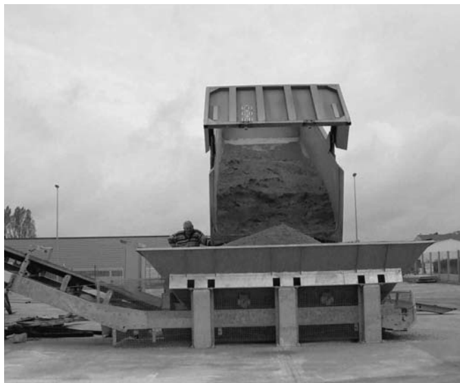
2. ábra Közvetlen adalékanyag töltés tehergépkocsiból
