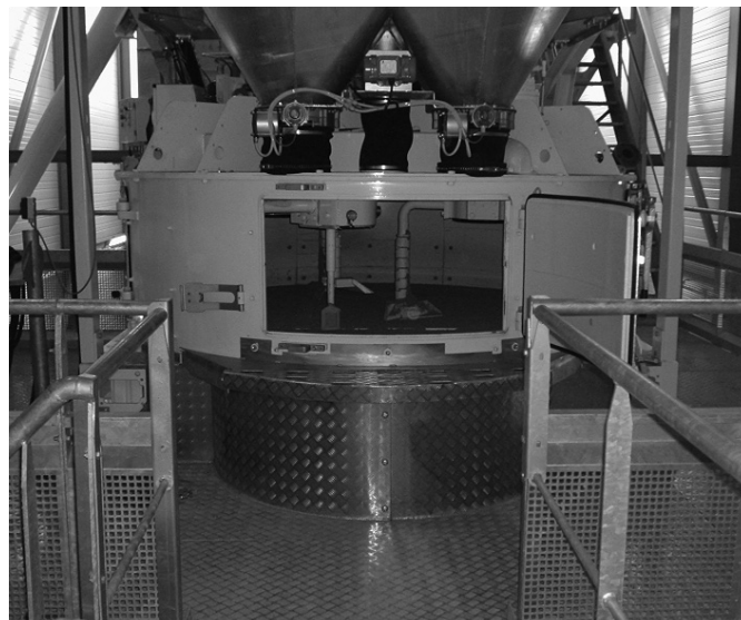
3. ábra Integrált keverő- és mérlegszint, SKAKO Dynamix keverővel
