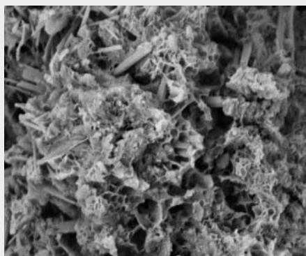
13. ábra Nanomodifikált betonjavító habarcs makrostruktúrája
