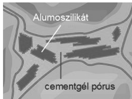
9. ábra Szilikapor és alumoszilikát adalékanyagok a cementkő porusvizében
