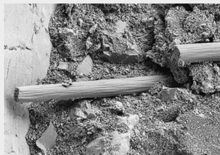
15. ábra A nanokristályokkal beágyazott szénszál a habarcsban
