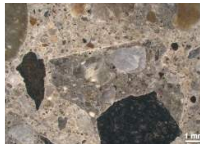
1-2. kép: Tört betonnal (b-j: pályabeton, térkő) készült betonok mikroszkópi felvételei
