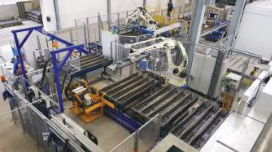
Huzal sablonba rakása és feszítése (ipari robotokkal)
