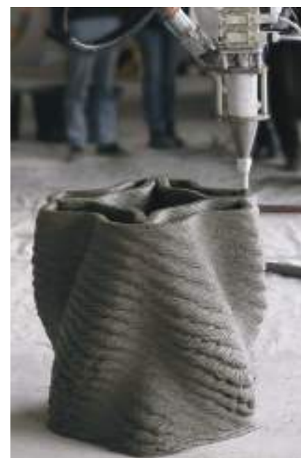
2. kép - Generatív tervezéssel optimalizált betonpillérek gyors kivitelezése (Fotó - Keerthana Udaykumar)
