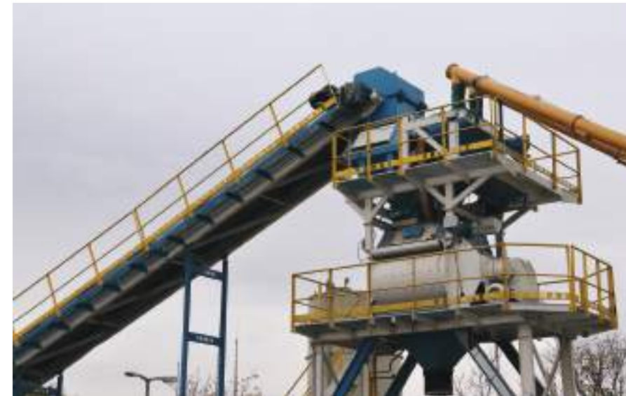
Új betonkeverő gép, Budapesten
