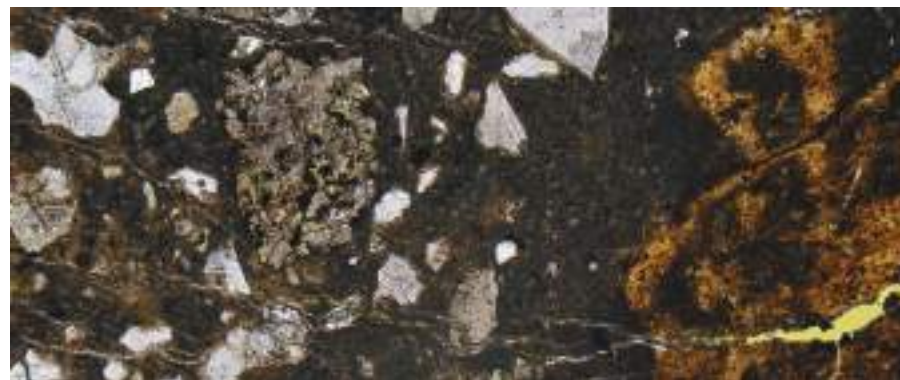
1. kép - ASR okozta repedések (forrás: petrol.co.uk)
