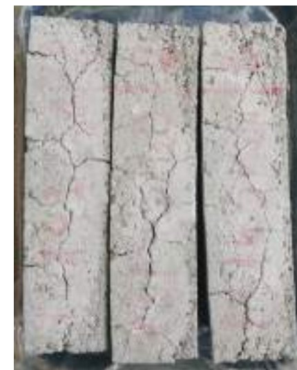
3. kép - ASTM C1260 szerinti vizsgálat során tönkrement próbatest (forrás: CEMKUT Kft.)
