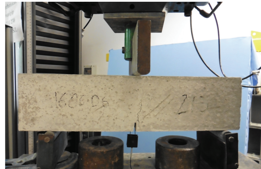
2. kép: Középpontos hajlító-húzószilárdság vizsgálat (forrás: Budapesti Műszaki és Gazdaságtudományi Egyetem, Építőanyagok és Magasépítés Tanszék fényképei, 2016)
