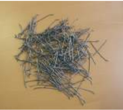
Acélszál statikai erősítésre (forrás: Betonmix Kft.)
