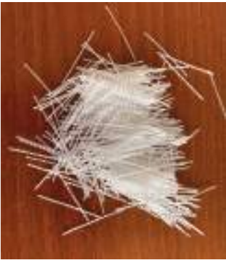
Polipropilén műanyagszál statikai erősítésre (forrás: Betonmix Kft.)
