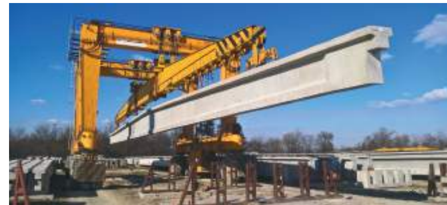
A tetőgerendák rakodása és deponálása a gyártóterületen
