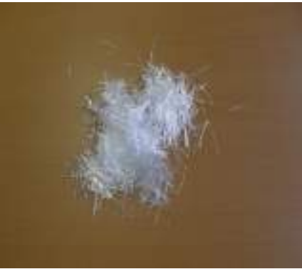
Polipropilén műanyagszál a zsugorodási hajlam csökkentésére (forrás: Betonmix Kft.)
