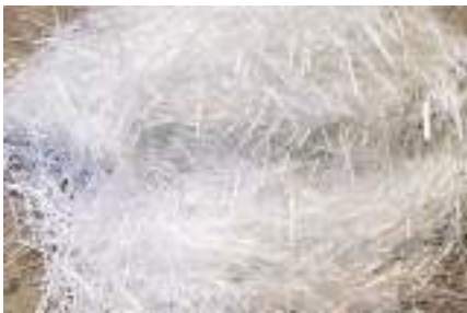
Üvegszál a zsugorodási hajlam csökkentésére (forrás: https://www.expressions-ltd.com )
