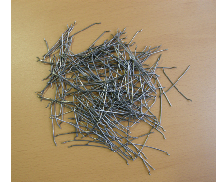
Acélszál statikai erősítésre (forrás: Betonmix Kft.)
