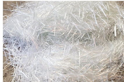
Üvegszál a zsugorodási hajlam csökkentésére (forrás: https://www.expressions-ltd.com )
