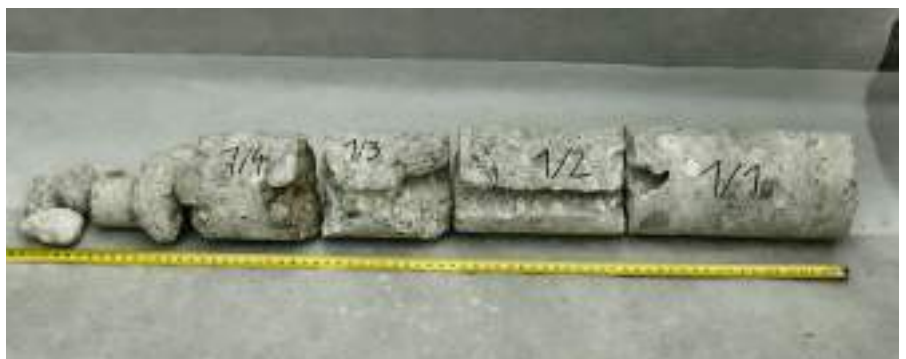
„Réteges” felépítésű fúrt beton minta csömösözléssel előállított betonlemezről
