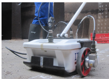
Radarvizsgálatok végrehajtása beton alaplemezen
