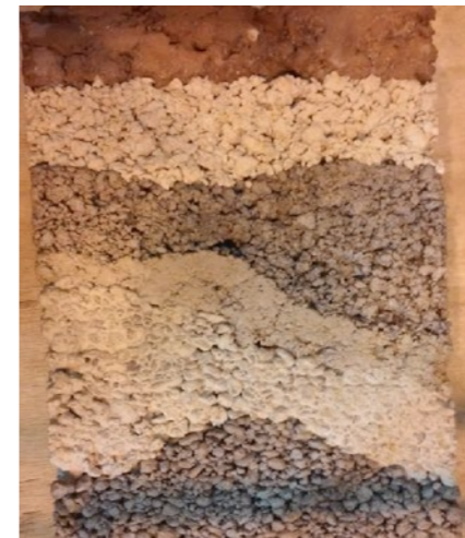
4. ábra: kb. 30x50 cm-es csömöszölt betonból készített próbakeverések
