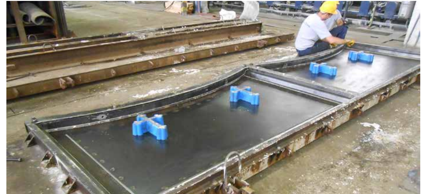
▲ A gyártószablon előkészítése
