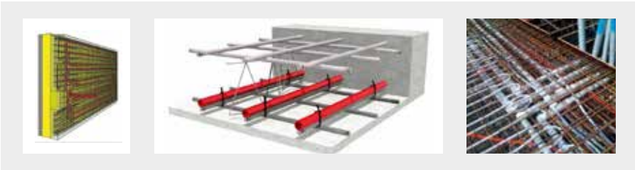
▲ 2. ábra: Termikusan aktivált betonelemek („betonmagtemperálás”) [8]
