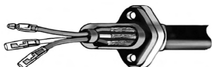
1. ábra A kábeleket műgyantás kiöntéssel védik a víztől
