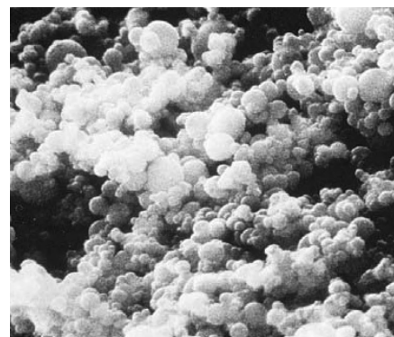
1. ábra Mikroszilika részecskék (www.cement.org)
