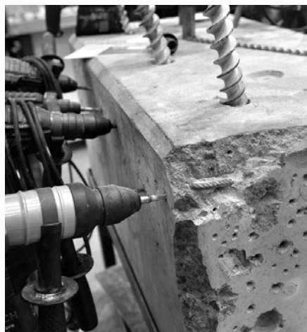
1. ábra Egy kép 2011-ből: betontömb fúrása különböző teljesítményű fúrókkel
