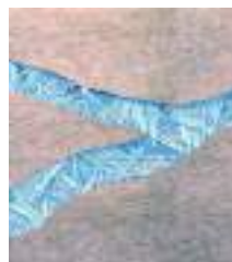
3-4. kép A Sika WT-200 sűrű kristálmátrixot képez a beton kapilláris rendszerében
