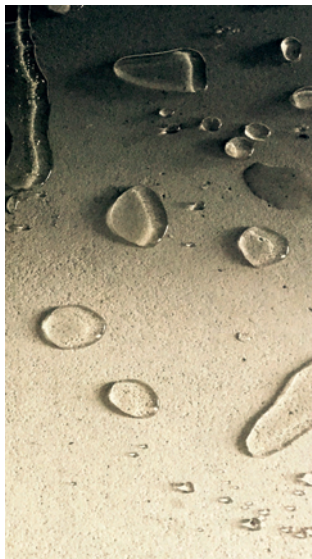
1. kép Az impregnálószerrel kezelt felület nem engedi magába a vizet
