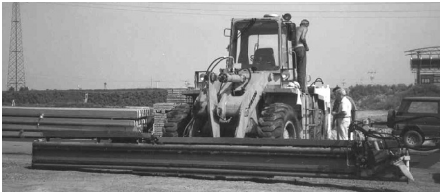
10. ábra A homlokrakodóból kialakított hézagoló gép a rászírt hézagoló gerendával
