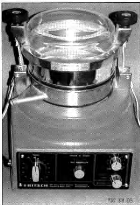
Szita berendezés az őrlési finomság meghatározásához. A Schulek Frigyes Kéttannyelvű Építőipari Műszaki Szakközépiskola laboratóriumának mérőeszköze. (A szerző fényképfelvétele)
