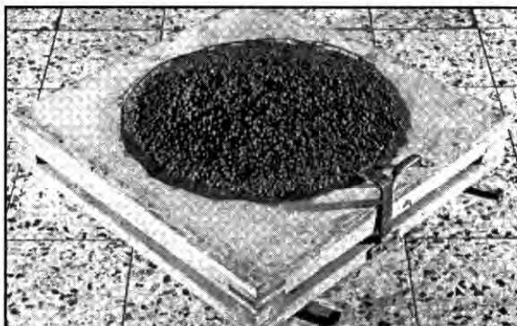
1. ábra Területi kísérlet a DIN 1048 szerint 1 \text{ kg/m}^3 beton ST 1 adagolásával és anélkül
